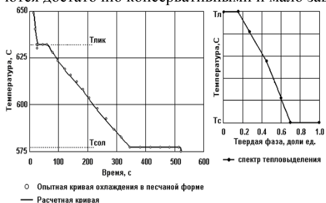
Рис.1 Кривые охлаждения для центра слитка Ø45мм из сплава Al-5%Si, заливаемого в песчаную форму и спектр тепловыделения
