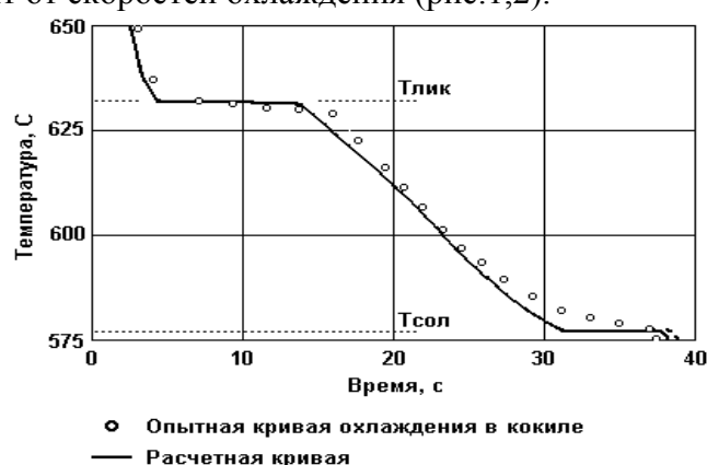
Рис.2 Кривые охлаждения для центра слитка Ø55мм из сплава Al-5%Si, заливаемого в кокиль.
