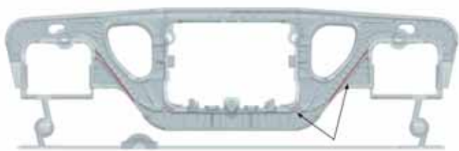
Места установки внутренних холодильников
