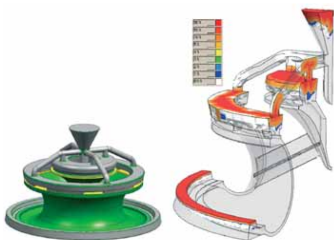
3D-модель литейного блока и результаты моделирования пористости в СКМ ЛП «ПолигонСофт»
