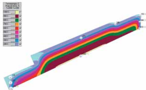
Температурное поле заготовки ротора после 1 часа охлаждения в масле
