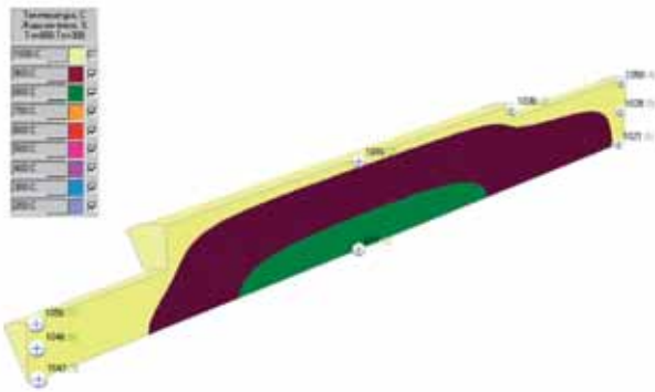
Температурное поле заготовки ротора на момент достижения печью температуры закалки
