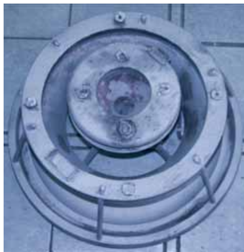
Готовая отливка «Корпус верхний». Голубая отливка получена после первой заливки
