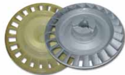
SLA-модель и готовая отливка
